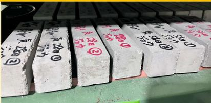
→ 各種配合の**強度** , **CO<sub>2</sub>固定量**を評価
