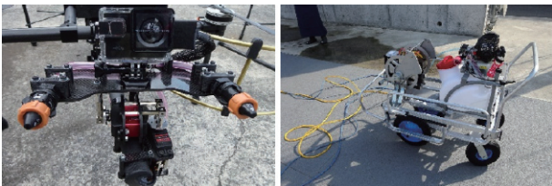
写真-8 自在ノズル (左), ポンプおよびバッテリー台車 (右)
