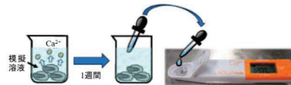
図-6 \text{Ca}^{2+} 溶出試験の手順
