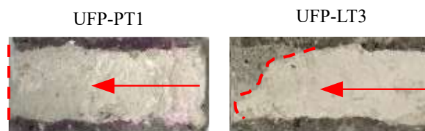
図-10 水中ひび割れ注入における注入材の動向
