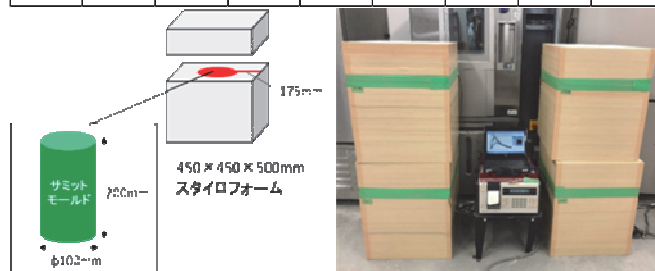
図-1 簡易断熱試験装置概要
