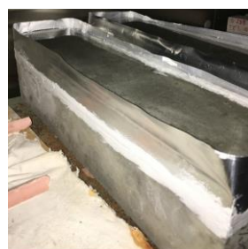
図-1 乾湿繰り返し試験状況
