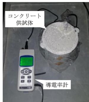
写真-1 導電率計測の様子
