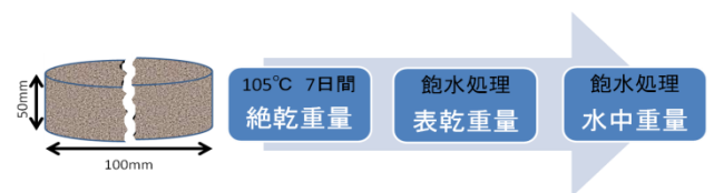
図-2 空隙率試験概要
