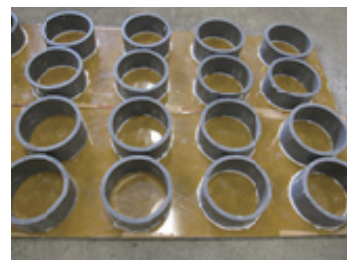
図-1 塩化ビニル管で作製した型枠
