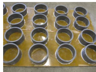
図-1 塩化ビニル管で作製した型枠
