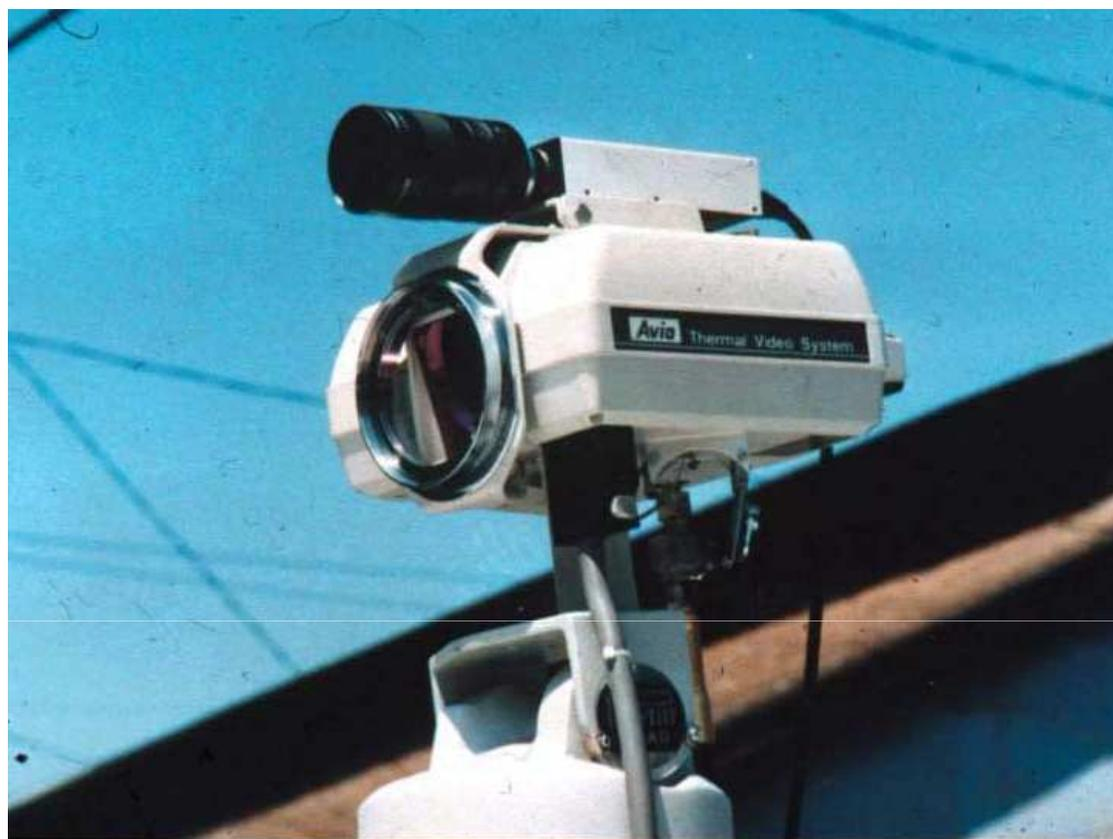
サーモグラフィーとは、物体表面から放射される赤外線を、検出素子を用いて二次元的に走査し、検出された赤外線量を映像として表示する方法
