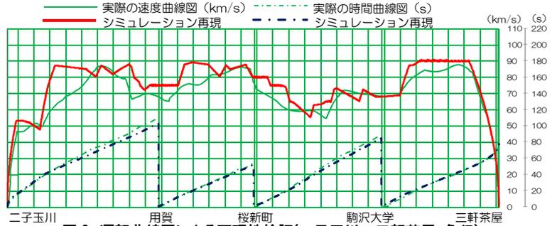
図 3 運転曲線図による再現性検証(二子玉川～三軒茶屋・急行)
