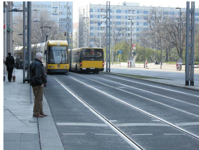
トラムの線路とバス路線との共有(同一 の電停で乗換スムーズ)
