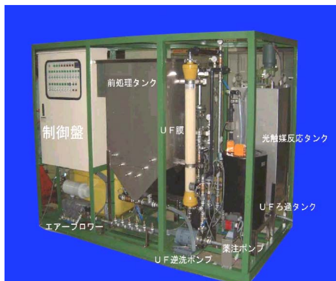
写真 - 1 実証機 (2m x 1m x 1.5m)
